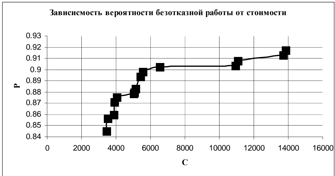
Рис.5. График зависимости надежности от стоимости комплектации СУ насосом
